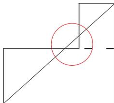
L-Flächen bei Überschneidung (siehe roter Kreis) in zwei Flächen einteilen und einspringende Ecke mittels geeigneter Fuge abtrennen
