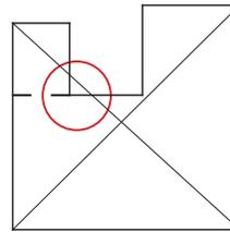
U-Flächen bei Überschneidung (siehe roter Kreis) mittels geeigneter Fuge abtrennen. Die verbleibende L-Fläche ist neu zu bewerten.
